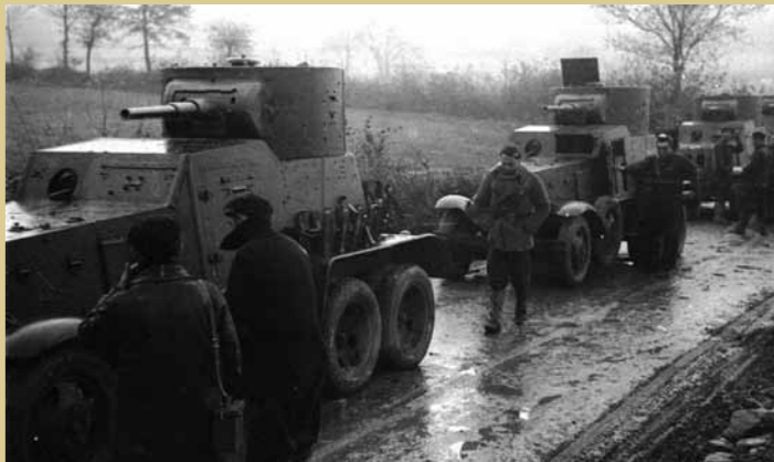
1 de diciembre de 1936. Blindados soviéticos -autometralladoras-cañón BA.6 y autometralladoras FA-I- dispuestos a iniciar el ataque por la carretera que, desde Reconco, baja hacia La Mata (Constantino Suárez. Muséu del Pueblu d’Asturies)
